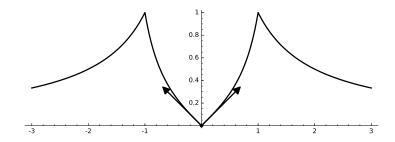
7. Par symétrie, si la courbe de f admet, en 0, une demi-tangente de pente  $\frac{1}{2}$  à droite, elle admet alors une demi-tangente de pente  $-\frac{1}{2}$  à gauche. La courbe de f présente donc un "angle" en 0. La fonction f n'est donc pas dérivable en 0.
